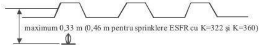
Figura 7.14 - Distanțe de amplasare a sprinklerelor față de marginea inferioară a unui plafon ondulat
