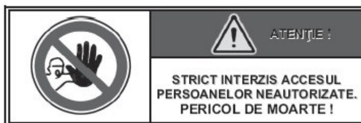
Figura 2.2. Indicator pentru avertizare pentru spațiile în care se depozitează butelii cu substanțe de stingere
